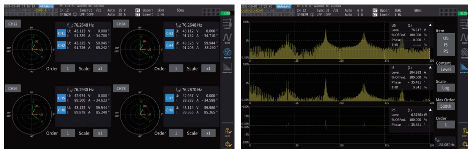
以 3P3W2M 配線的 4 變頻器、馬達的向量分析範例
