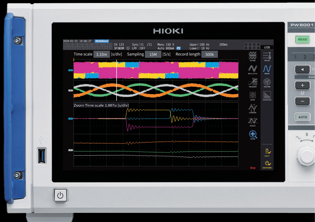
通過直觀的旋鈕操作，可以調整波形的顯示位置、觸發以及諧波次數
